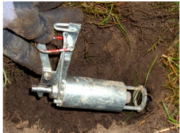
Wenn Fallen mit Erde verwühlt werden, hilft der Kieferle Schussapparat weiter. Er wird mit einer Platzpatrone geladen und tief in einen Wühlmausgang geschoben.
