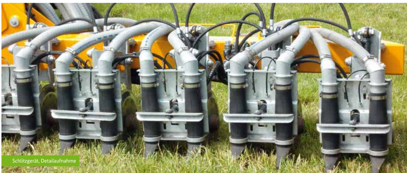
Scheibenschlitzgerät für die Gülleeinbringung zwischen den Reihen
