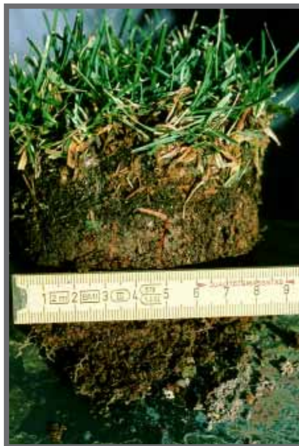
Bild 9: Lehmige, humose Rasentragsschicht, Bodengruppe 6
