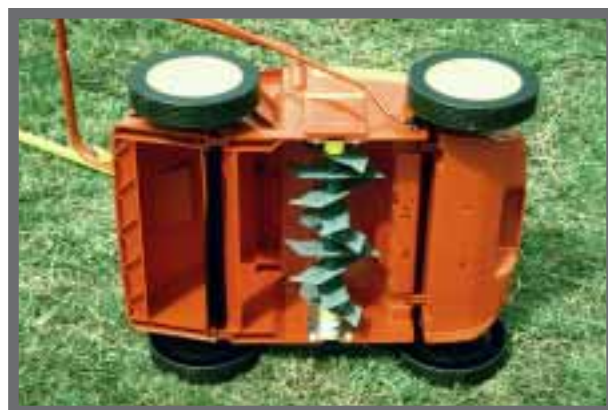
Bild 39: Die Vertikutiermesser sollten nur bis zur Bodenoberfläche reichen.
