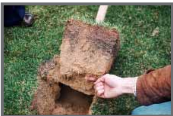
Bild 8: Für belastbare Sportrasen muss die Rasentragsschicht sandig sein.
