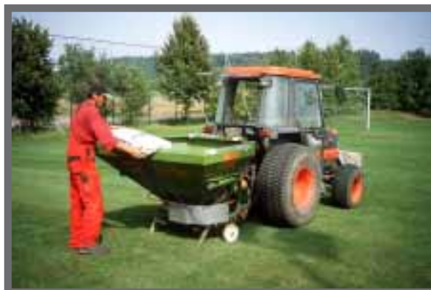
Bild 19: Ein Anbau-Düngerstreuer sorgt für exakte Verteilung.
