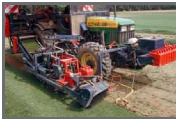
Bild 22: Abschälen der 40 cm breiten Kleinrolle.
