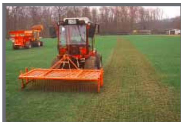
Bild 40: Ein Vertikutierstriegel erlaubt die großflächige und schnelle Beseitigung von Rasenfilz.
