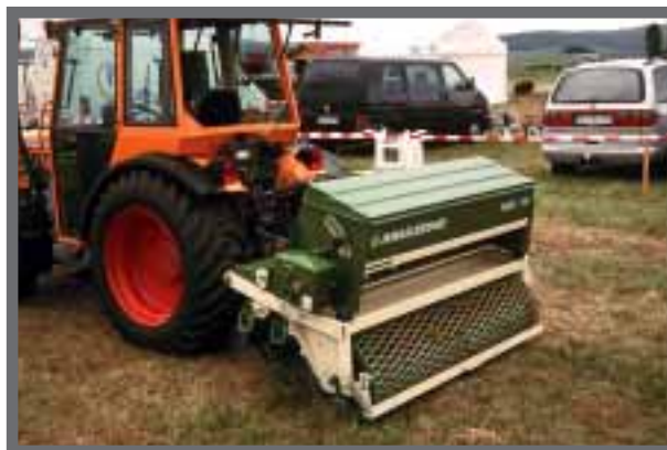
Bild 13: Anbau-Rasensäkombination Amazone GBK 15 mit 1,50m Arbeitsbreite für den großflächigen Einsatz.
