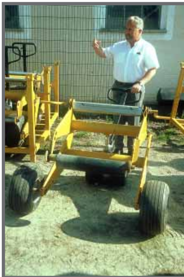
Bild 27: Rollrasenpionier Horst Schwab mit einem Verlegegerät für die 60cm breite Rolle.
