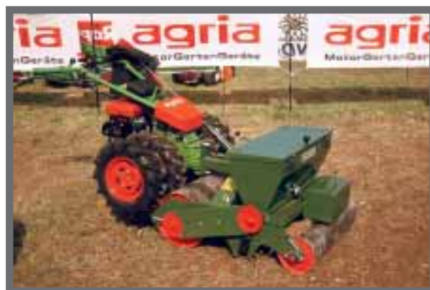
Bild 12: Anbau-Rasenbaumaschine Sembdner RS 80-A an Einachsschlepper.
