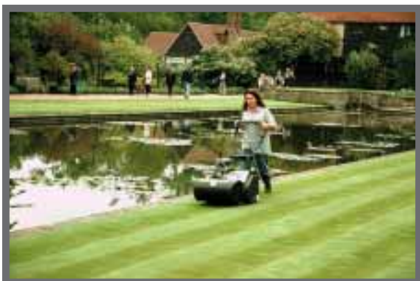
Bild 31: Der Spindelmäher erzielt das beste Schnittbild ...
